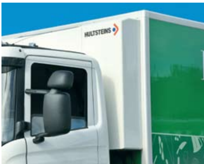
Modell HS215 är ett aggregat framtaget för två temperaturzoner med långsgående mellanvägg. Aggregatet monteras utanpåliggande på framstam mellan skåp och hytt.
