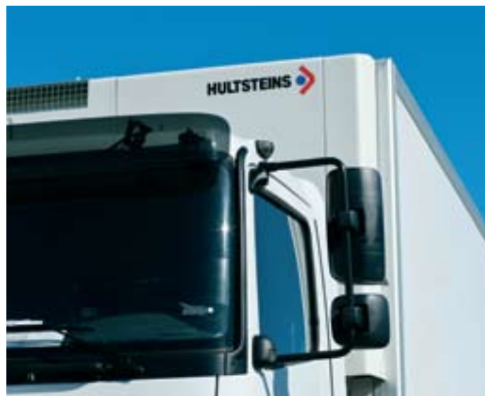
Modell HS monteras utanpåliggande på framstam mellan skåp och hytt. HS finns i fyra effektstorlekar och i olika funktionsutföranden.
